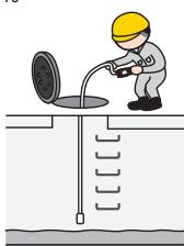
Pour les mesures à l'intérieur de réservoirs
